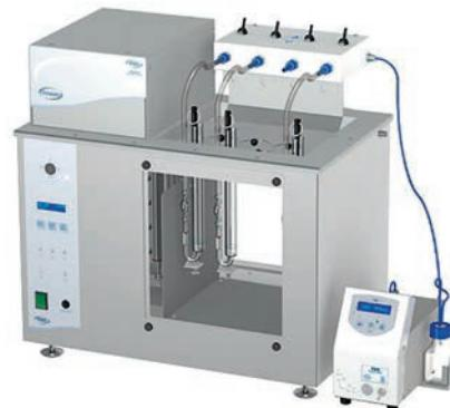
Установка для определения вязкости битумов
