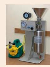
● Стенд для определения общего загрязнения топлива в соответствии с EN 12662, ГОСТ Р 52368.
