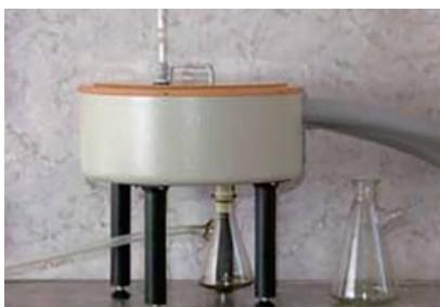
Аппарат для фильтрования используется в методах «А» и «Б».
