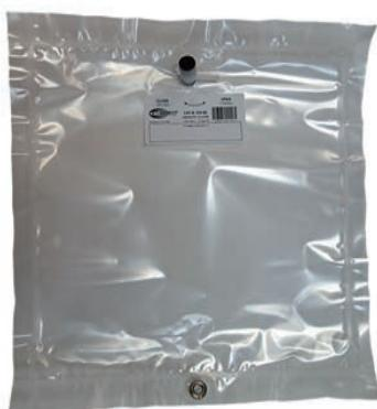
Пробоотборные пакеты – надежное средство отбора проб газов и паров. Это особенно важно, когда концентрация определяемого компонента близка к пределу чувствительности аналитических приборов. Пакеты изготовлены из инертных материалов и позволяют надежно сохранять пробу газа.
