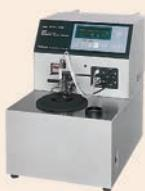
● Автономный автоматизированный аппарат для определения предельной температуры фильтруемости.
