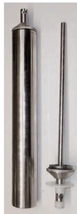
Пробоотборник RNS 502 предназначен для взятия пробы, дающей информацию обо всем содержимом резервуара. Он постепенно заполняется жидкостью во время спуска от поверхности ко дну резервуара. Пробоотборник имеет специальный клапан, пропускающий жидкость только во время движения пробоотборника сверху вниз. Клапан закрывается, если спуск пробоотборника временно прерывается и остается закрытым, пока пробоотборник не будет извлечен из резервуара.
