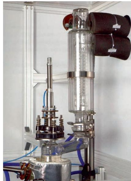
Высокоэффективный тройной холодильник имеет большую поверхность теплообмена, образуемую двумя отдельными внутренними змеевиками и двойной внешней рубашкой, которая предотвращает конденсацию влаги и тепловые потери.
