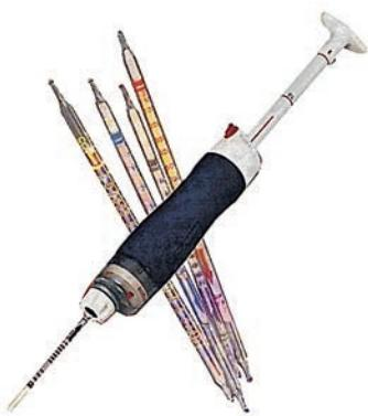
Определение газов с помощью газодетекторных трубок основано на изменении окраски слоя сорбента под действием определяемого газа, прокачиваемого через трубку с помощью насоса. Концентрация определяемого газа пропорциональна длине изменившегося окраску слоя. Она считывается либо по шкале, нанесенной на трубку, либо по концентрационной диаграмме.
