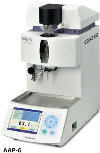
Анализатор AAP-6 выполняет автоматическое определение анилиновой точки как прозрачных, так и мутных образцов с помощью модифицированной U-образной ячейки с вакуумной рубашкой и сливным краном. Простота обращения с анилиновыми смесями обеспечивает безопасность. Возможность работы с мутными и темными образцами расширяет область применения метода.
