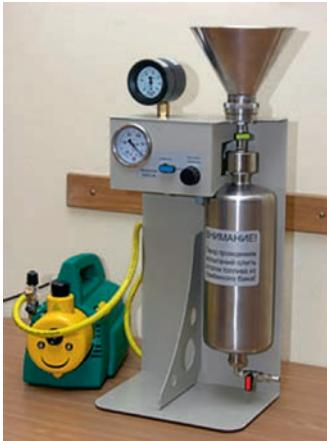
Данный стенд может быть использован для определения содержания механических примесей в сырой нефти в соответствии с рекомендациями ASTM D 4807
