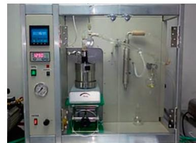
Установка для вакуумной разгонки нефти, используемая в методе «Б»
