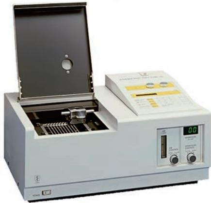
Iatrosan MK6. Под крышкой справа видно сканирующее устройство с пламенно-ионизационным детектором.
