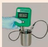
● Прибор для измерения удельной электропроводности в соответствии с ГОСТ 25950, ASTM D2624.
