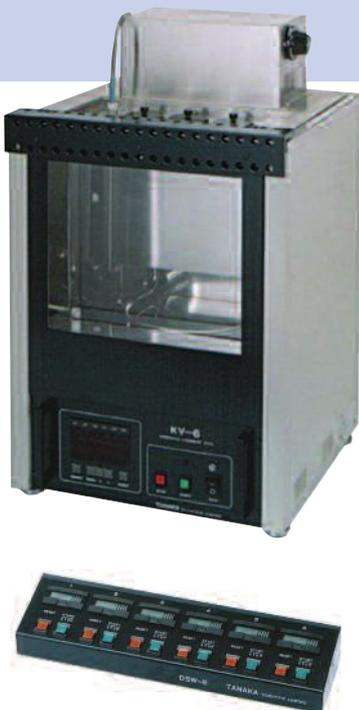
Объединенные в компактную систему баня, температурный контроллер и цифровые секундомеры. Баня на 6 вискозиметров типа Кэннон-Фенске или Уббелоде имеет пластиковую крышку, лампу для подсветки и спираль для пропускания охлаждающей жидкости. Дополнительно – блок из 6 электронных секундомеров.
