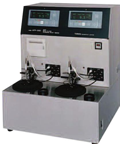
Автоматически выполняют анализ нефтепродукта, определяя предельную температуру фильтруемости (ПТФ), в соответствии с методами **IP 309, ASTM D6371, JIS K2288, EN 116, ГОСТ 22254.**
